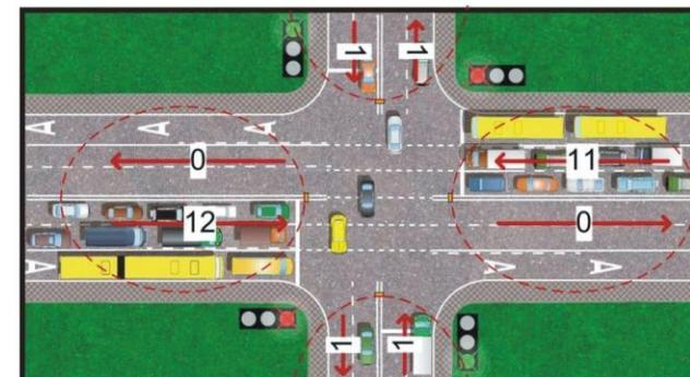
Датчик способен подсчитывать количество транспортных средств, движущихся по направлению на датчик и от него отдельно. Эта информация может быть использована в системах адаптивного светофорного регулирования для оптимизации движения и снижения вероятности возникновения пробок на автодорогах.
