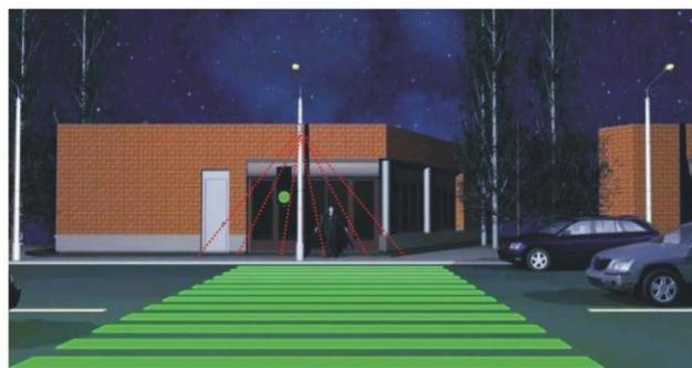
Управление пешеходными переходами по присутствию: автоматическое увеличение светового потока светильников, управление светофором без кнопок.
