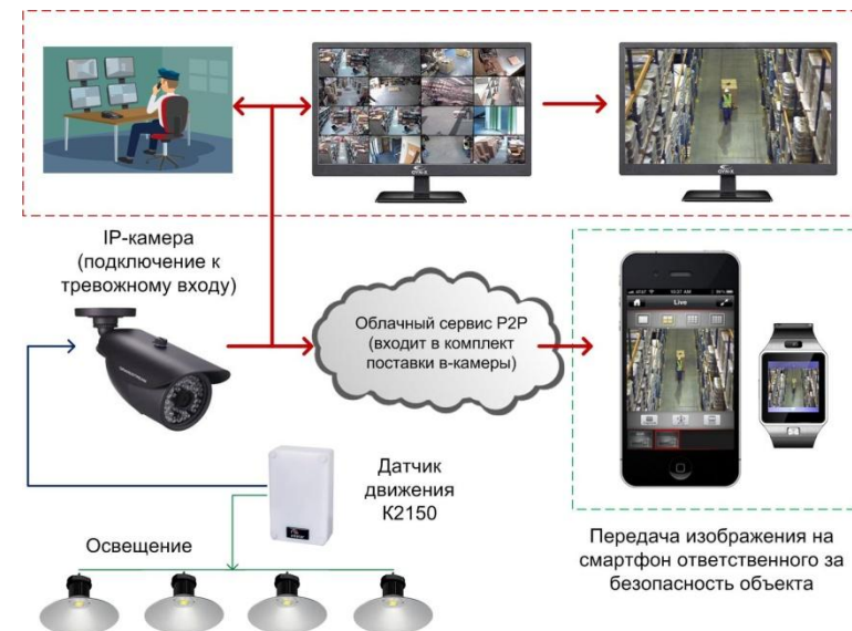
Рис. 7 Работа датчика K2150 в комплексе с системой видеонаблюдения объекта
